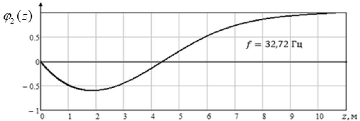
Рис. 113. Друга форма власних крутильних коливань
