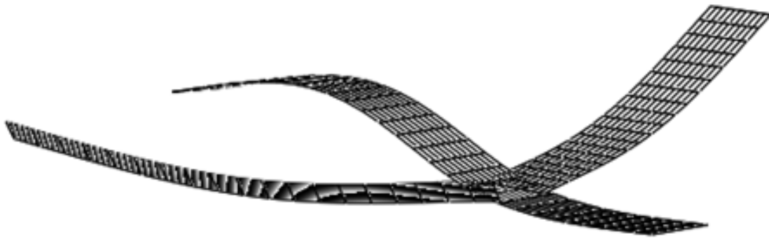
Рис. 99. Симетричний другий тон пружних коливань
